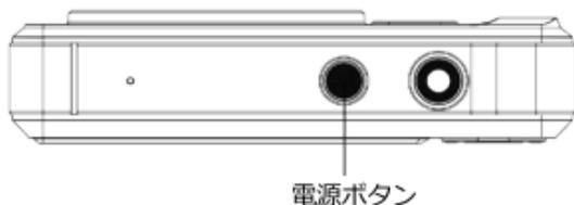
カメラの電源をオフにするには、電源ボタンを約3秒間 長押しします。
