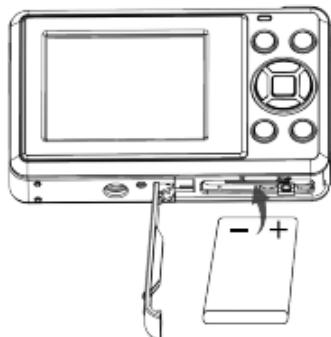
バッテリーの+ - を左図の通りにして、端子部分を本体側に向け、バッテリー固定つまみが「カチッ」と鳴るまで差し込みます。
